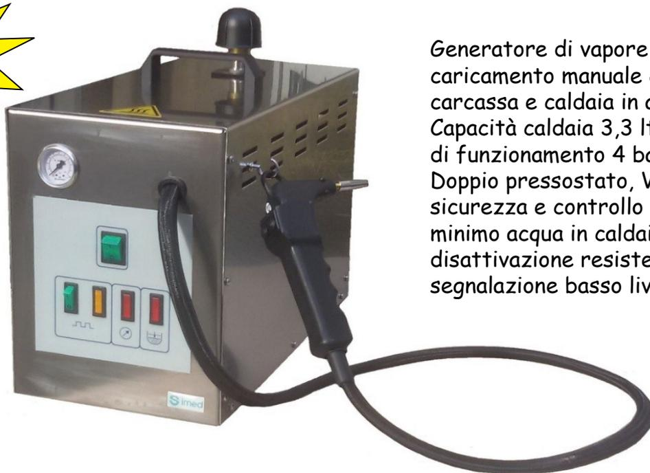
Generatore di vapore a caricamento manuale con carcassa e caldaia in acciaio inox. Capacità caldaia 3,3 Lt, pressione di funzionamento 4 bar. Doppio pressostato, Valvola di sicurezza e controllo livello minimo acqua in caldaia con disattivazione resistenza e spia segnalazione basso livello acqua.
