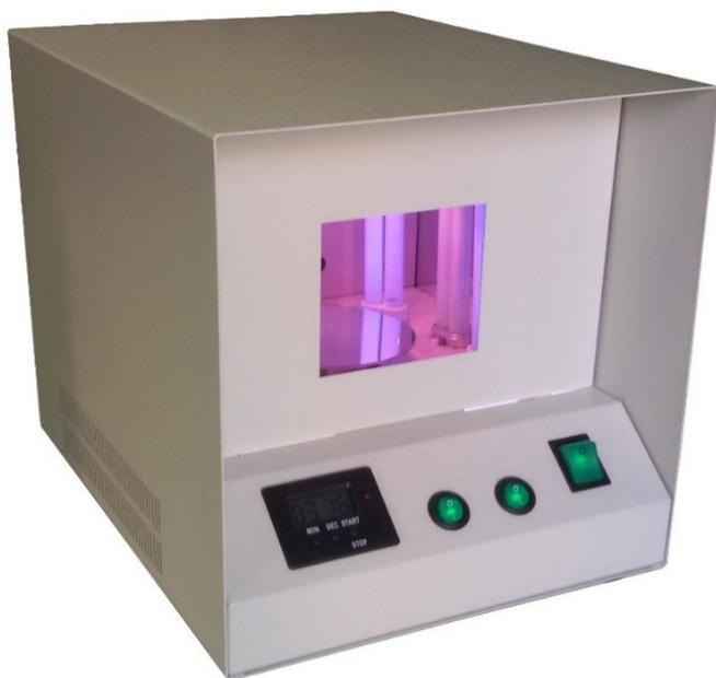
8 lampade UV e 2 lampade dicromatiche specifiche per la fotopolimerizzazione dei compositi dentali garantiscono la copertura di uno spettro d'emissione da 320 a 550 nm e l'indurimento di tutti i materiali fotosensibili.
