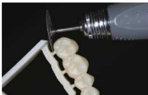
Rimozione dei supporti
